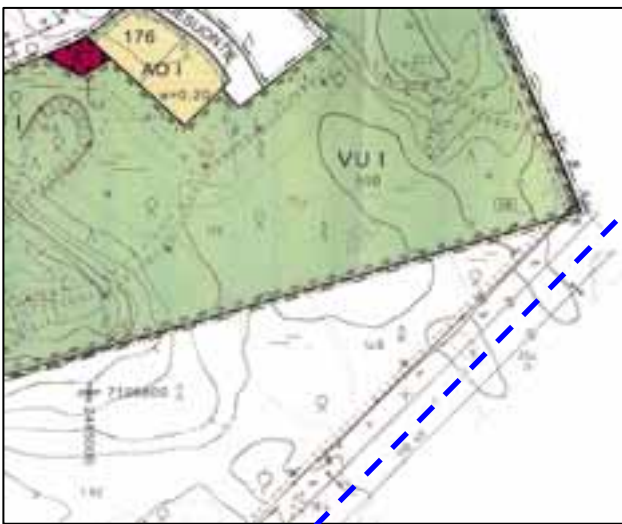
Kuva 148. Ote Himangan Kirkonseudun asemakaavasta. Voimajohto sijoittuu kuvassa 400 + 110 kV yhteispylväisiin nykyisten purettavien johtojen keskelle (sininen katkoviiva).
