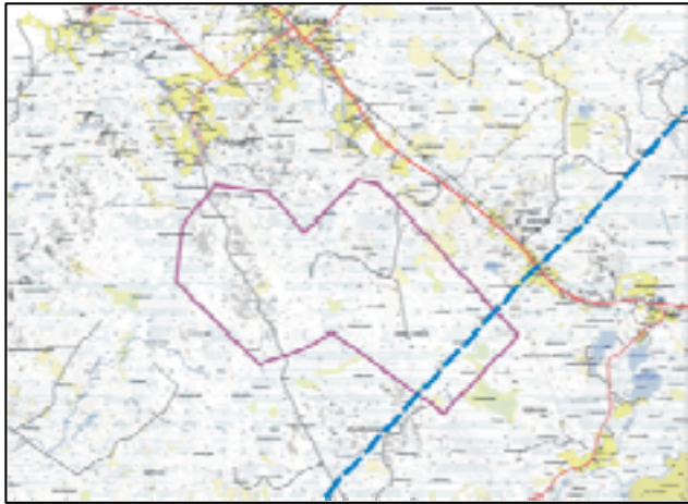
Kuva 153. Kopsan tuulivoima-alueen osayleiskaavan alustavasta rajaus. Voimajohto sijoittuu kuvassa nykyisen johdon rinnalle (sininen katkoviiva).
