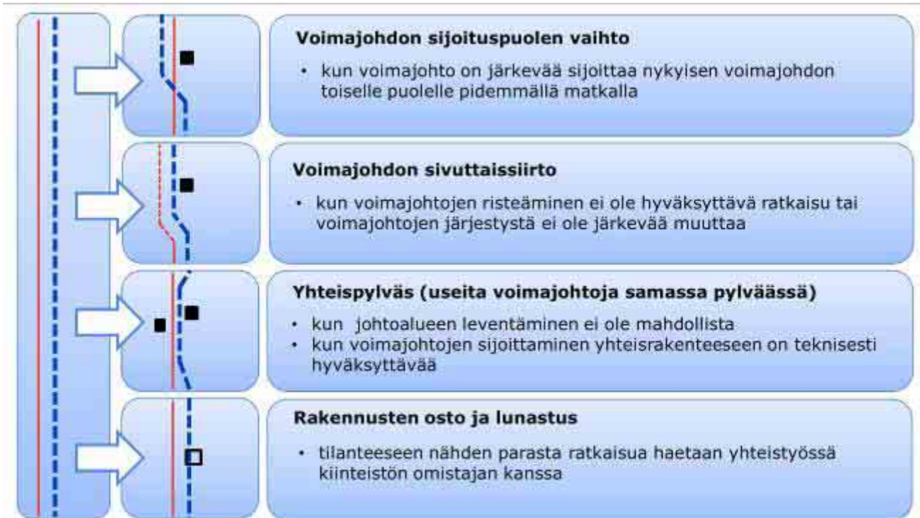
Kuva 4. Periaatteellisia esimerkkejä tavanomaisesta poikkeavista ratkaisuista haasteellisissa suunnittelutilanteissa. Käytettävissä olevat vaihtoehdot ovat aina tapauskohtaisia.
