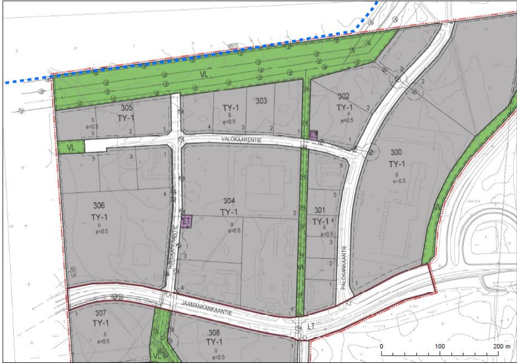
Kuva 3-10 Ote Kontiolahden Jaaman teollisuusalueen asemakaavasta (kv 25.1.2010). Tarkasteltava kaavaan merkitty voimajohto on korostettu sinisen värisellä katkoviivalla havaittavuuden lisäämiseksi.
