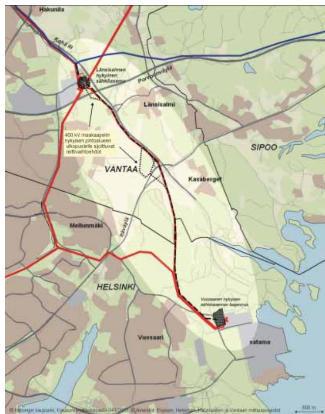
Kuva 3-5. Pääasiallinen selvitysalue ja vaihtoehdot. Nykyiset 110 kV voimajohdot on merkitty punaisella ja 400 kV voimajohdot sinisellä. Uuden 400 kV voimajohdon sijainti on esitetty mustalla katkoviivalla ja kaapelivaihtoehdon sijainti mustalla pisteiviivalla, niiltä osin kuin se sijoittuu nykyisen johtoalueen ulkopuolelle.
