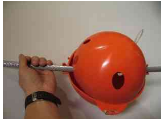
Kuva 14-1. Lintujen törmäysriskiä voidaan pienentää merkitsemällä johtimet riskialttiissa kohdissa huomiopalloilla.
