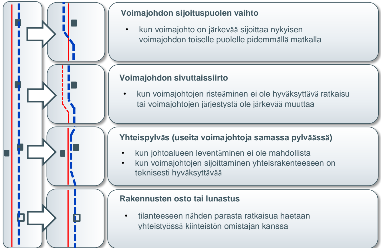
Kuva 8. Periaatteellisia esimerkkejä tavanomaisesta poikkeavista ratkaisuista haasteellisissa suunnittelutilanteissa. Käytettävissä olevat vaihtoehdot ovat aina tapauskohtaisia.
