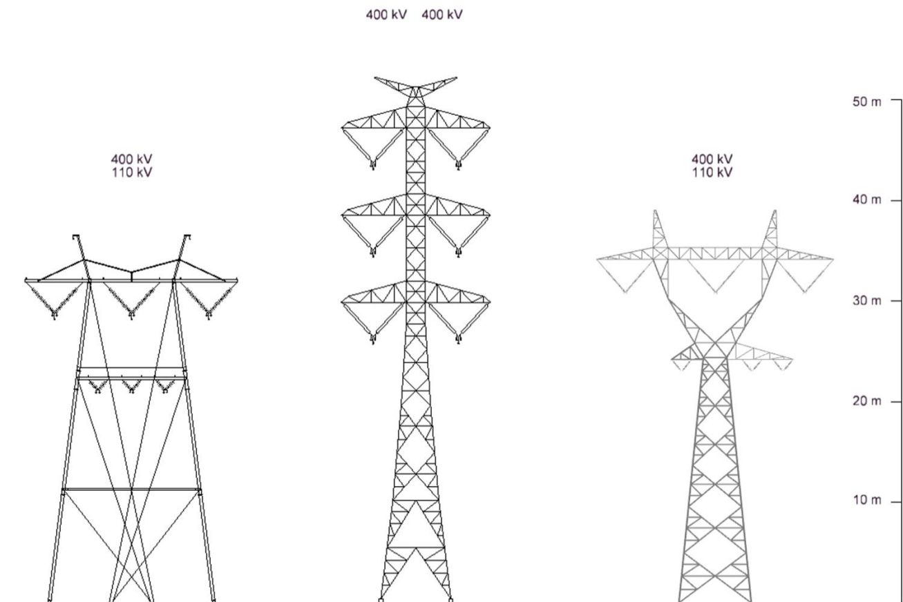
Kuva 9. Yhteispylvästyyppejä. Vasemmalla 400+110 kilovoltin harustettu portaalipylväs, keskellä kahden 400 kilovoltin voimajohdon "Tannenbaum"-pylväs ja oikealla 400+110 kilovoltin Y-pylväs.
