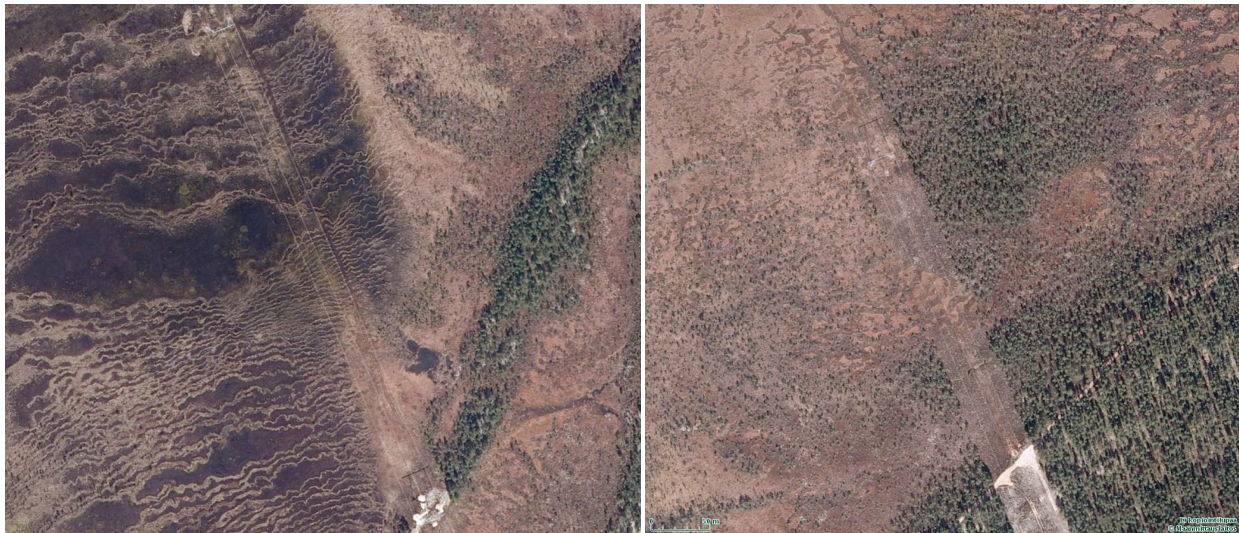
Kuva 6. Puuttomalla avosualueella muutoksia ei ole juurikaan nähtävillä pylväspaikkoja lukuun ottamatta. Hiekkaisilla kaarroilla puusto puuttuu ja karukkokankaalla on nähtävissä eroosiota (vasen kuva). Rämeillä näkyy muutos selvemmin puuston poistumana sekä mätäspinnan osittaisena muuttumisena (oikea kuva).
