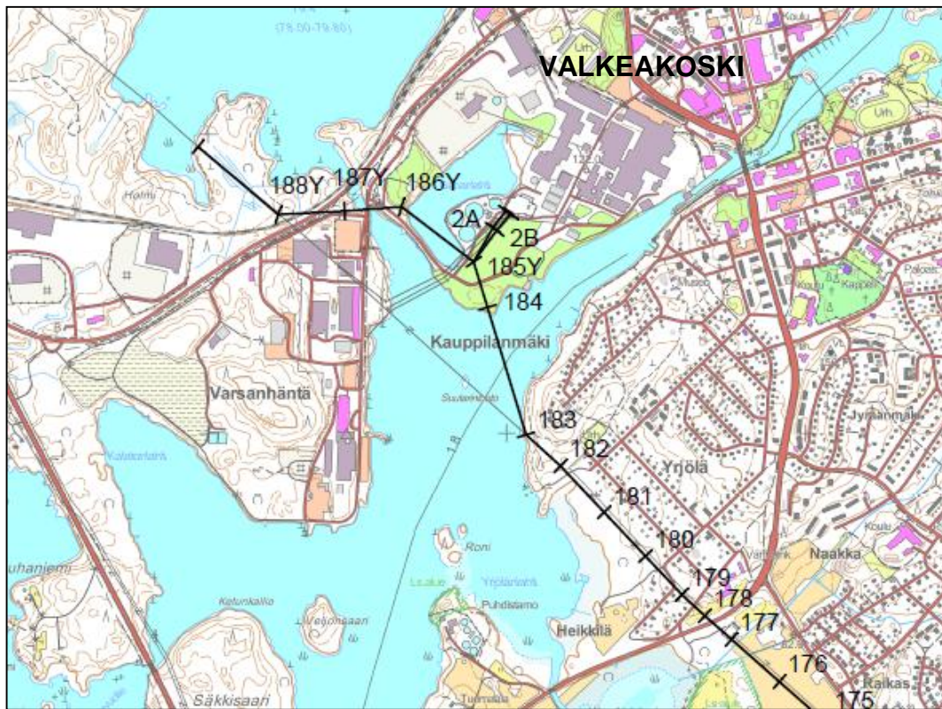
Kuva 2. Selvitetty 110 kilovoltin voimajohdon reittimuutos, pylväsvälit 183–188Y
