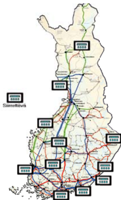
Fingridin sähkönlaadun analysointiin käytettävien mittareiden sijainti kantaverkossa.
