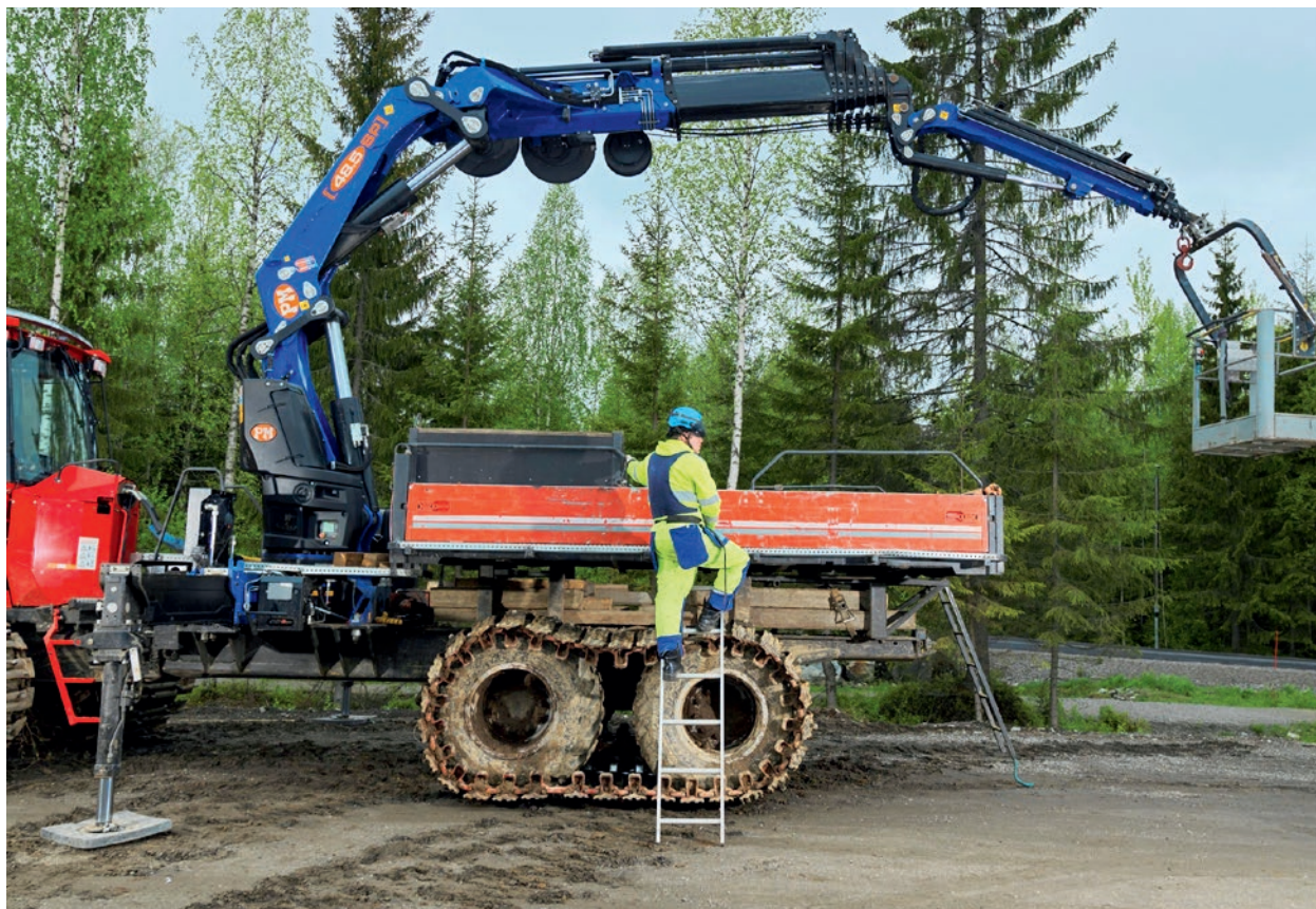
Metsäkoneen kulkuteitä kehitettiin lisäämällä tikas ja porrasratkaisuja, kulkusiltoja ja kaiteita.
