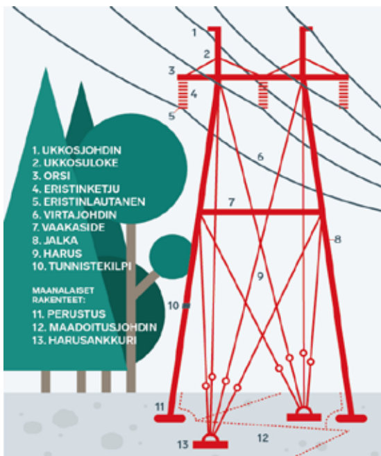
Kuva 2. Voimajohdon ja johtoalueen osat.
