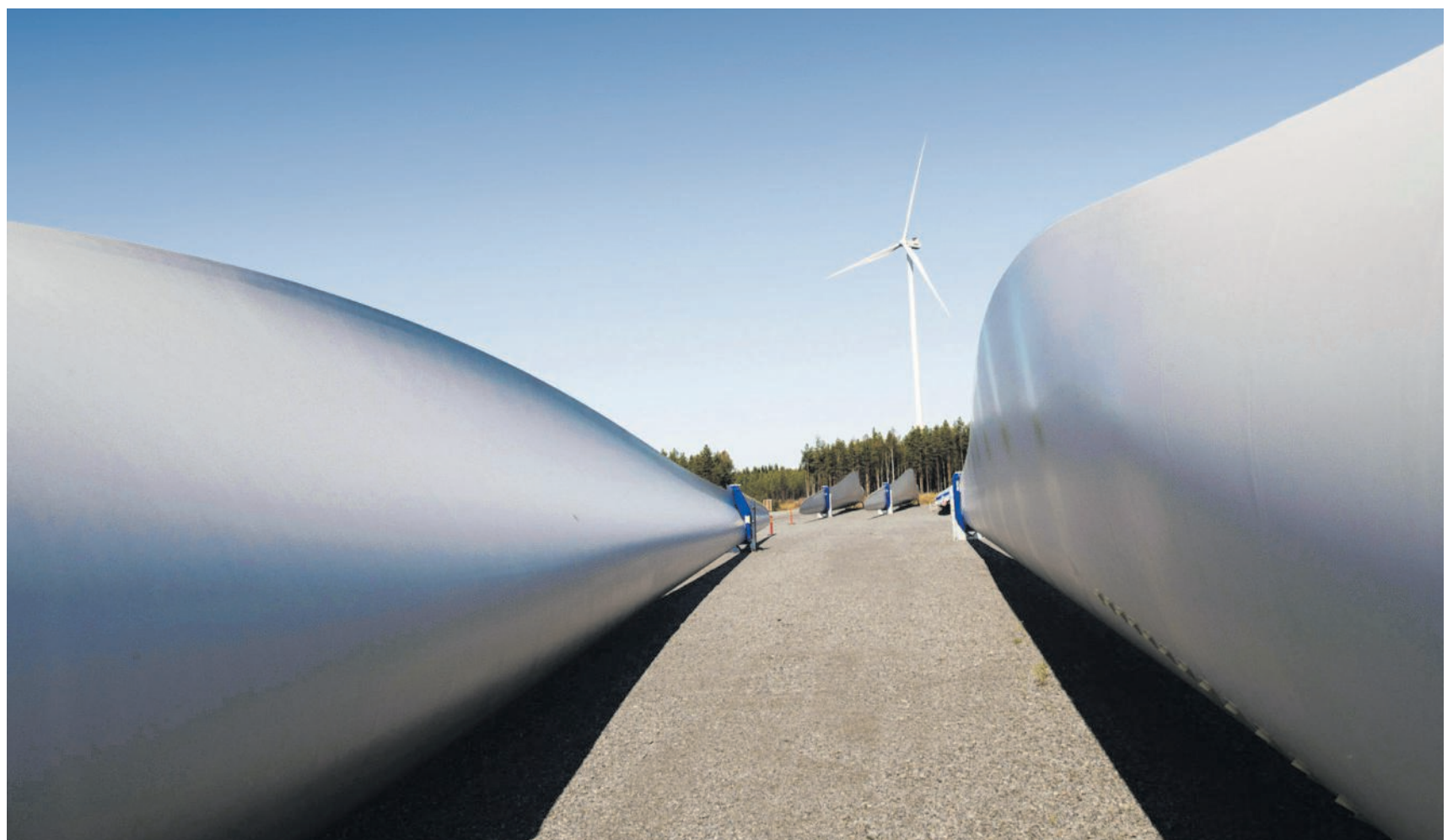
Tuulivoimaloiden siipien pituus on kasvanut viimeisen viiden vuoden aikana, eli nyt tuulesta saadaan merkittävästi enemmän energiaa kuin aikaisemmin. Kuva on Kristiinankaupungin tuulivoimapuistosta.
