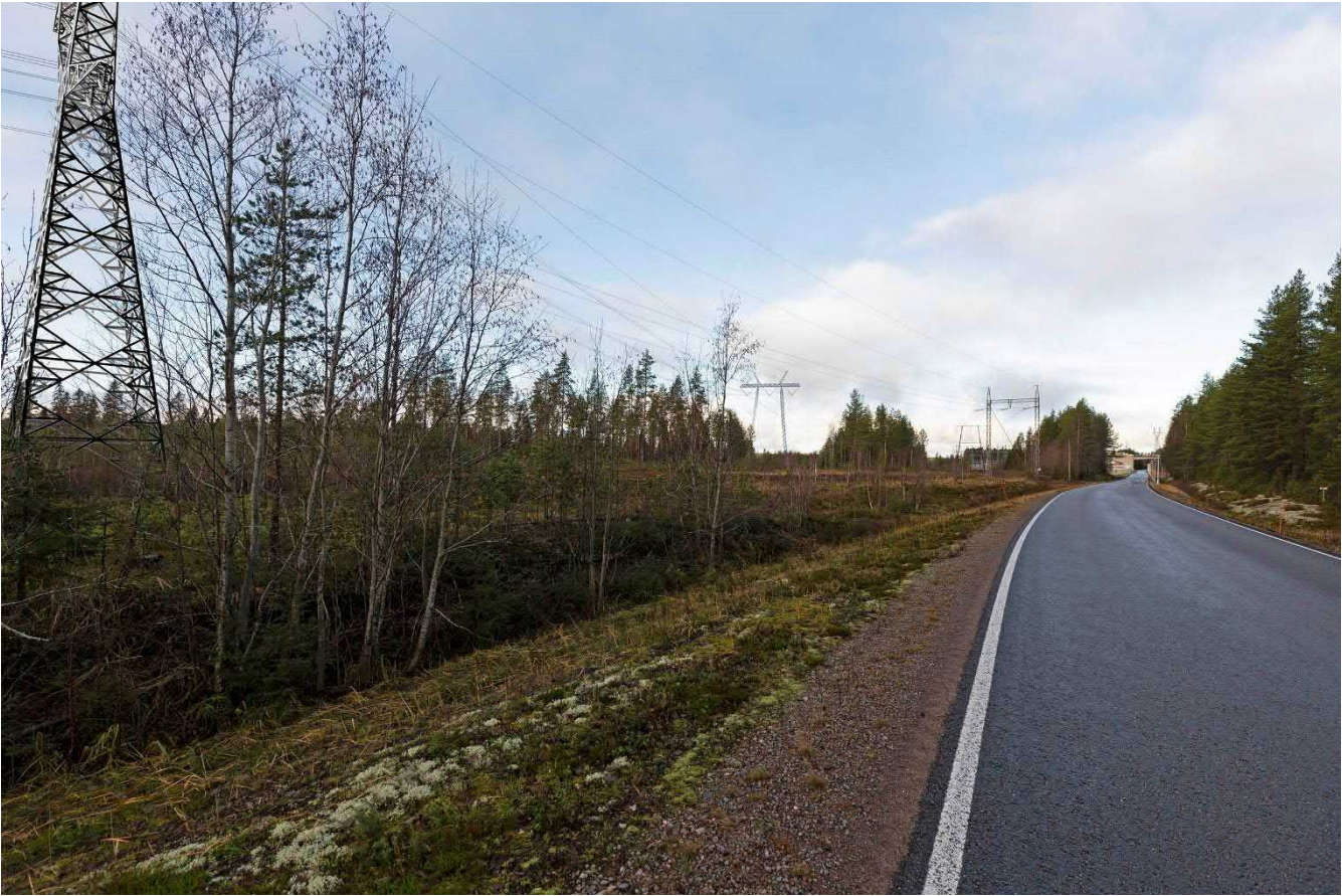
Kuva 8-10. Havainnekuva B näkymä Jylhämäntieltä Nuojuan voimalaitoksen suuntaan. Vasemmalla näkyy uusi 400 +110 kilovoltin Y-pylväs, josta 400 kilovoltin voimajohdot kääntyvät vasemmalle kuvan keskellä (objektiivivi 16 mm).
