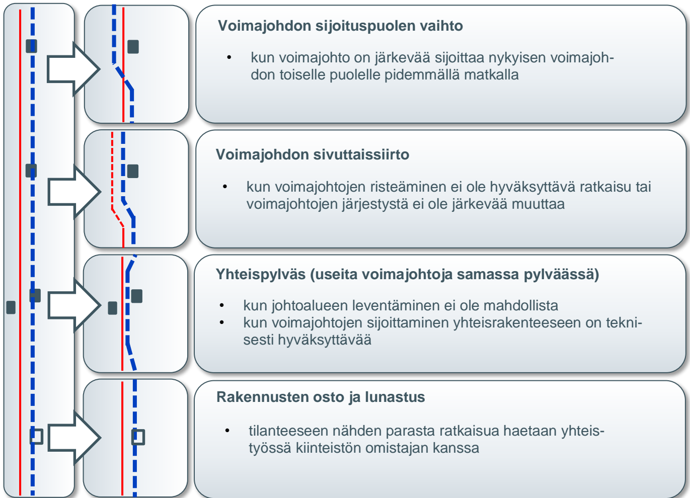
Kuva 2-2. Periaatteellisia esimerkkejä tavanomaisesta poikkeavista ratkaisuista haasteellisissa suunnittelutilanteissa. Käytettävissä olevat vaihtoehdot ovat aina tapauskohtaisia.
