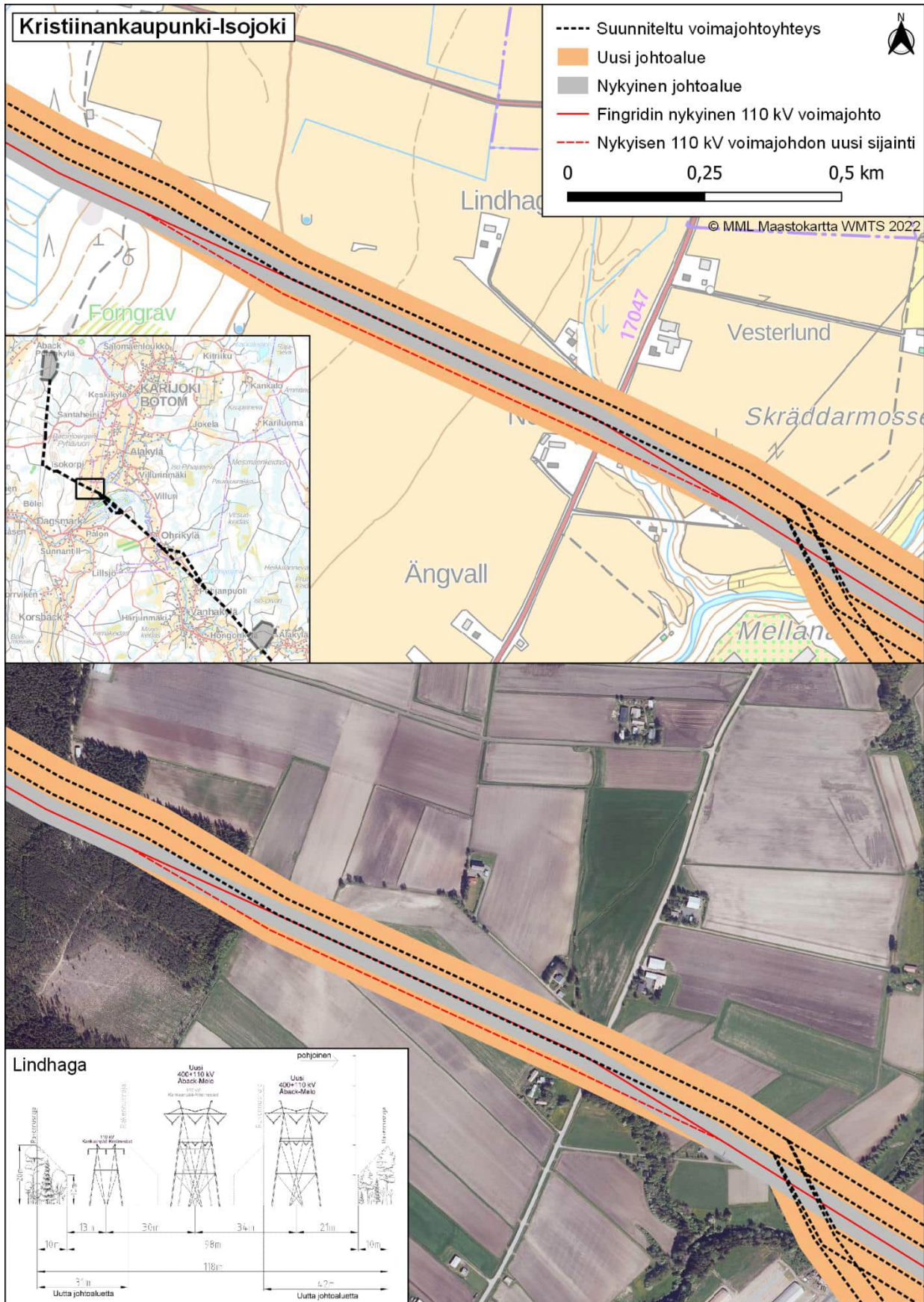
Kuva 4.5. Nykyisen 110 kilovoltin voimajohdon siirto etelämpään Lindhagan alueella, jotta uudet voimajohdot mahtuvat sen pohjoispuolelle.
