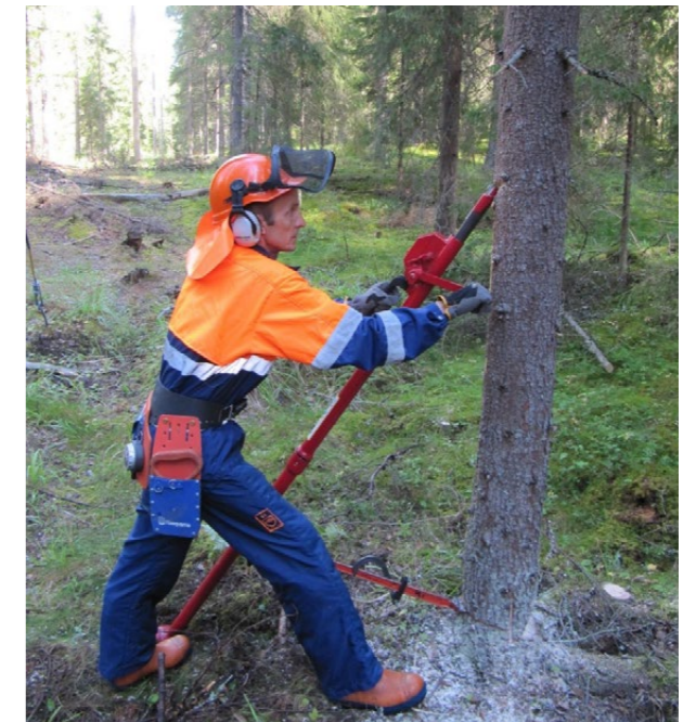
Kuva 23. Puun kaato kaatorautaa ja tunkkia käyttäen
