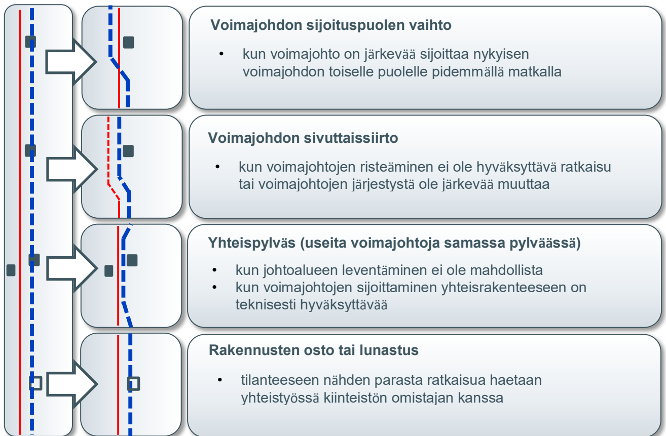
Kuva 8. Periaatteellisia esimerkkejä tavanomaisesta poikkeavista ratkaisuista haasteellisissa suunnittelutilanteissa. Käytettävissä olevat vaihtoehdot ovat aina tapauskohtaisia.
