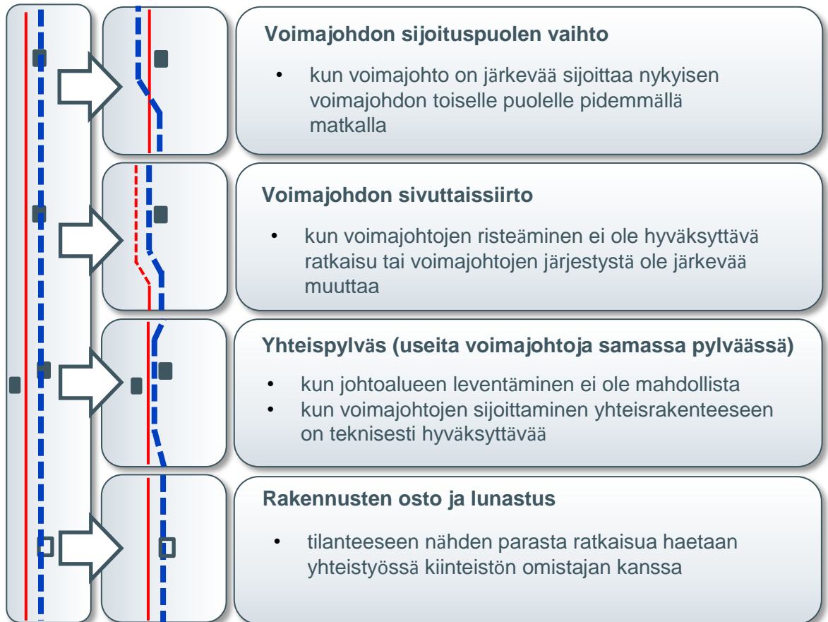
Kuva 3.2. Periaatteellisia esimerkkejä tavanomaisesta poikkeavista ratkaisuista haasteellisissa suunnittelutilanteissa. Käytettävissä olevat vaihtoehdot ovat aina tapauskohtaisia.
