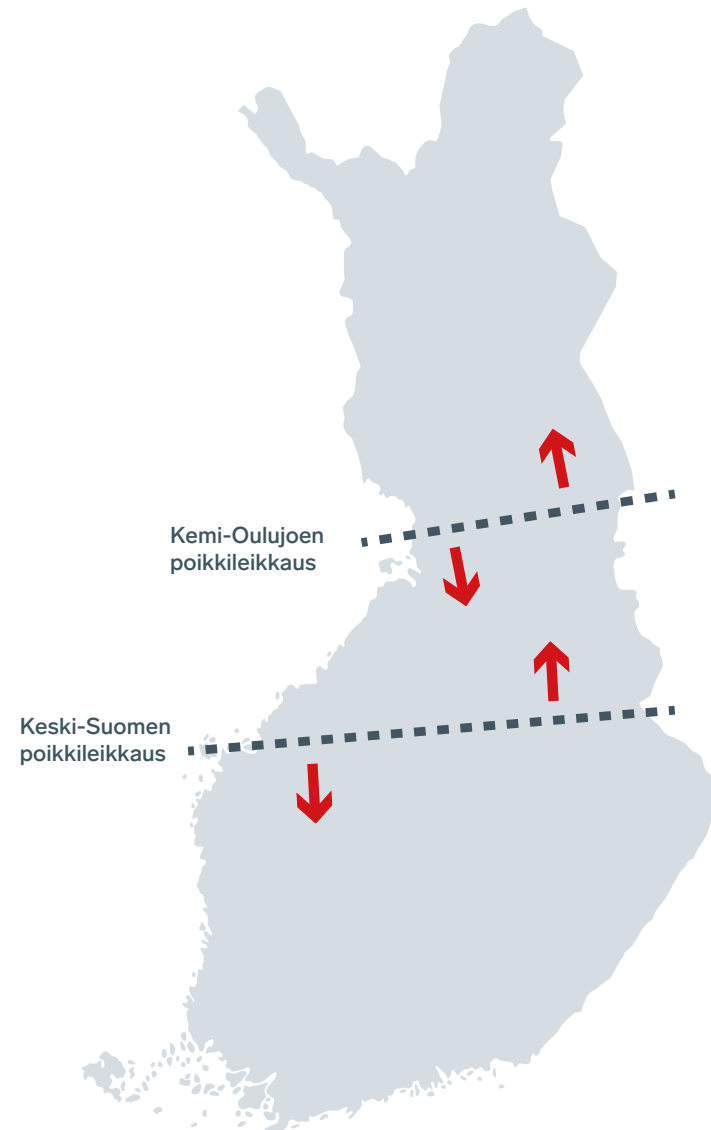
Kuva 5 Suomen sisäiset pääsiirtoleikkaukset. Tulevaisuudessa leikkausten sijainnit voivat muuttua muun muassa sähkön tuotannon ja kulutuksen sijoittumisen seurauksena.
