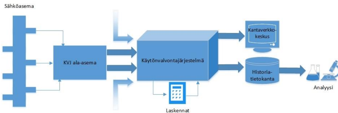
Kuva 5. Fingridin käytönvalvontajärjestelmän tiedonkulun periaatekaavio.
