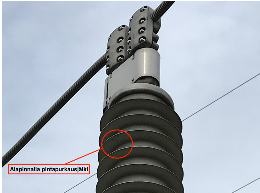
Kuva 22. Pinta- tai liukupurkauksen aiheuttama hiilijälki eristeen pinnassa.
