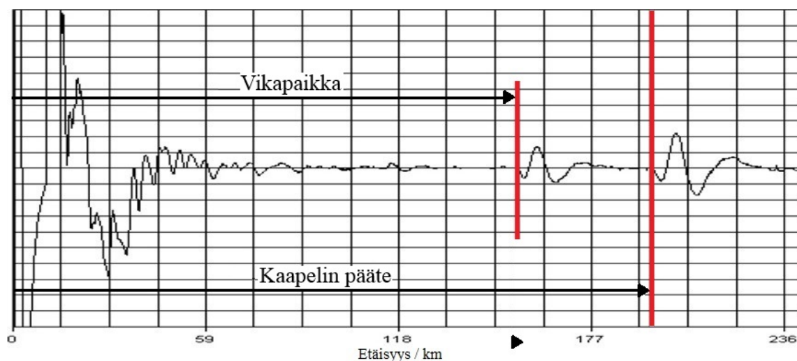
Kuva 22: Vikapaikan TDR-mittaus Teleflex M -kaapelitutkalla helmikuussa 2012 Fenno-Skan 2 -kaapelilla. Vikapaikkaa osoittava punainen pystyviiva on kohdassa 154 km ja kaapelipäätettä osoittava punainen pystyviiva kohdassa 196 km.
